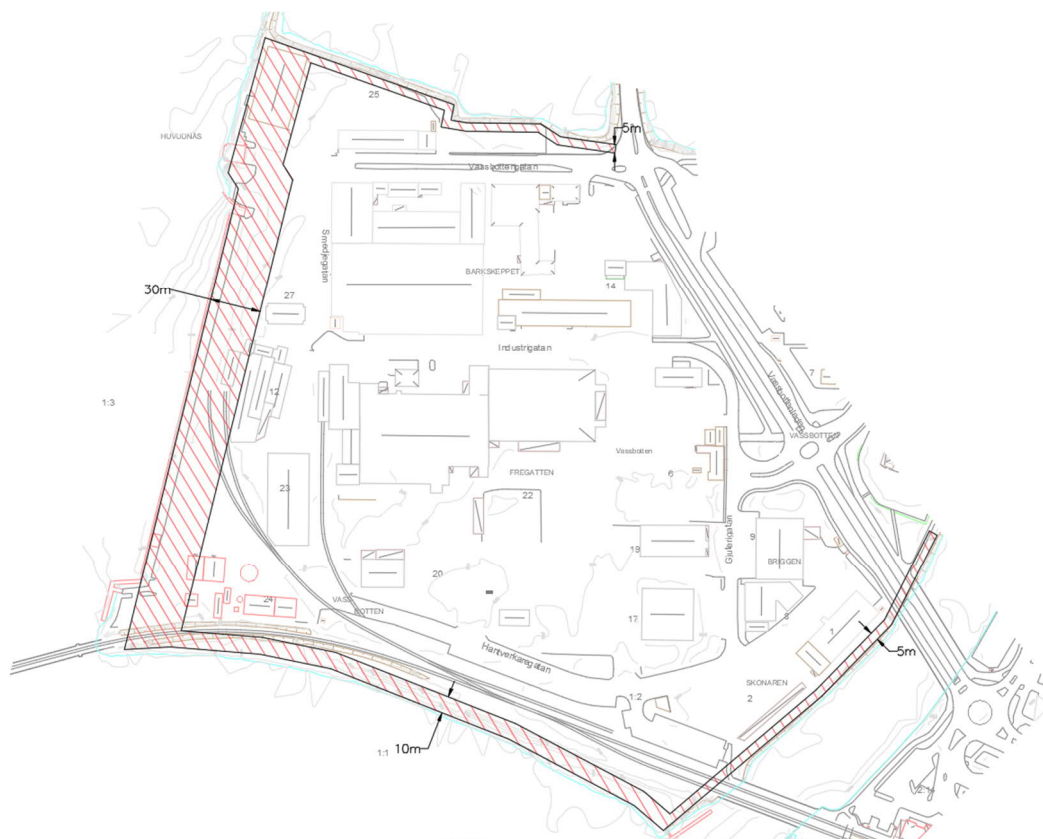
Bild 10 – Marken inom streckat område uppfyller inte erforderlig säkerhetsfaktor avseende stabilitet. Bredden på det streckade området anges från släntrön in mot landområdet.
